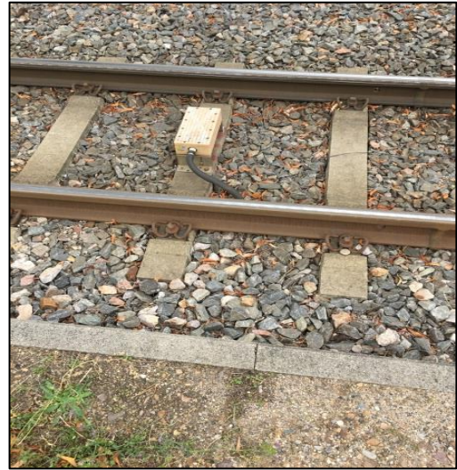
Abbildung 11-22: Koppelspule Typ B
